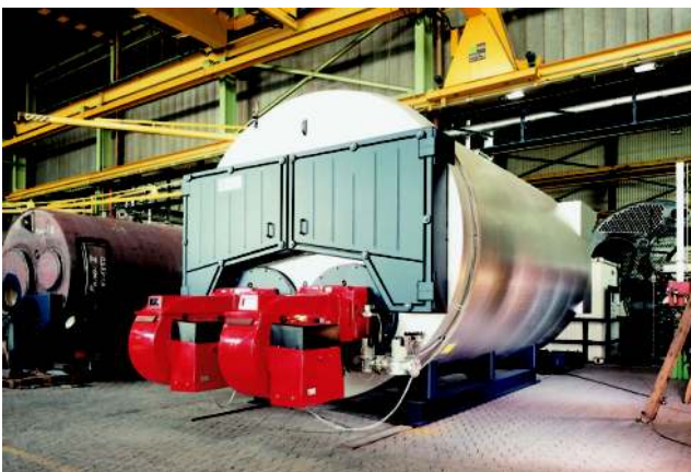
Bild 1: Versandfertiger LOOS-Hochdruck-Großwasserraumkessel in Zweiflammrohrbauweise, 35 t/h, 16 bar in der Endmontage
