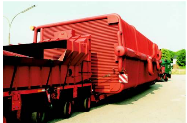
Bild 2: 100 MW Heißwasser-Wasserrohrkessel beim Transport
